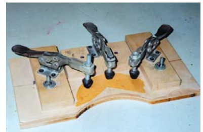
Gabarito para usinagem - Grampo 225-U
