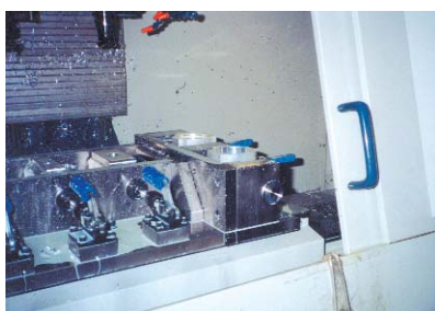
Usinagem de carcaça de alumínio para tomada de força hidráulica - Grampo 520
