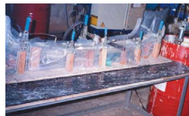
Enchimento de PU / pára-choque para automóveis - Grampo 110-DS
