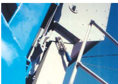
Fixação com suporte para peneira classificadora de grãos - Grampo 349-D
