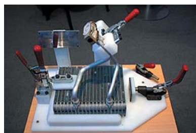
Teste de estanqueidade Grampos I07-DB/TR - 507
