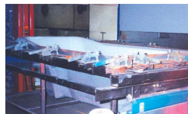
Dispositivo moldagem de banheira de hidromassagem (vacuum forming) - Grampo 135-D
